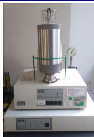
**2-10 汎用型熱分析測定システム (DTA,DSC,TMA)**
